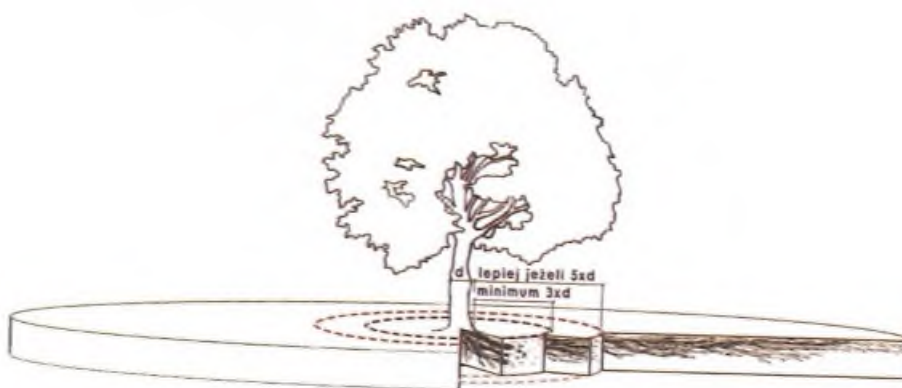
Ryc. 36. Minimalna odległość cięcia korzeni ze względu na statykę drzewa od pobocznic pnia (Smiley 2008, rys. Świder)
